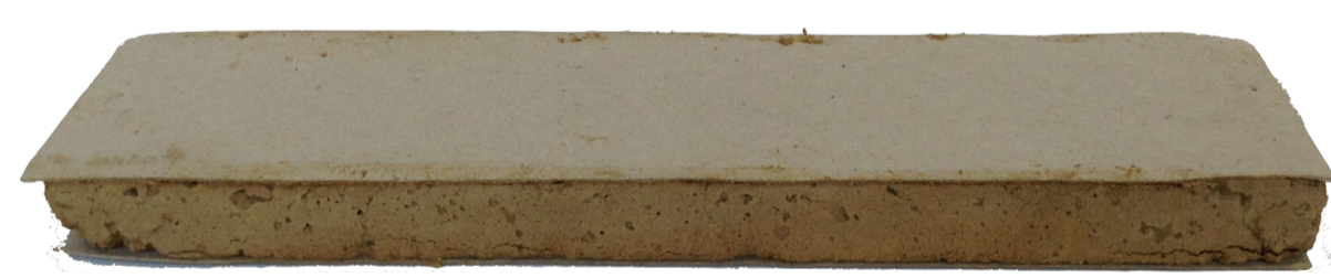
Probekörper nach DIN 18948 mit den Maßen 160 x 40 x 12,5 mm (Quelle: Eigene Darstellung)
