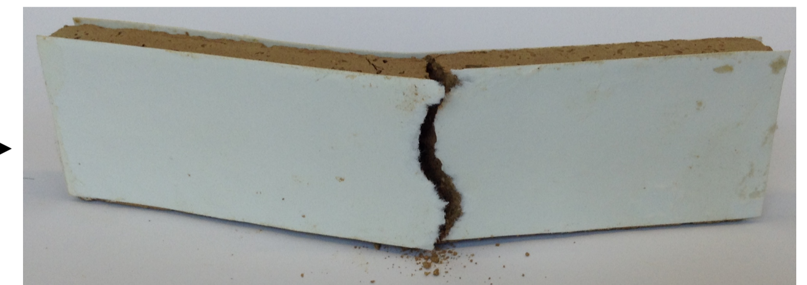
Versagensbild der Probekörper nach Biegezugprüfung (Quelle: Eigene Darstellung)
