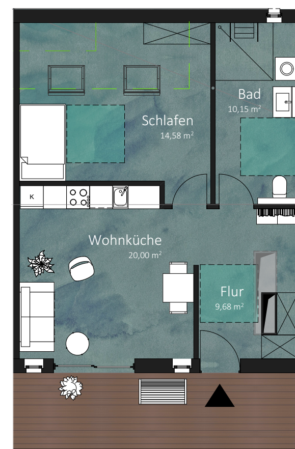
Grundriss kleine Wohnung, Single, barrierefrei M 1:100
